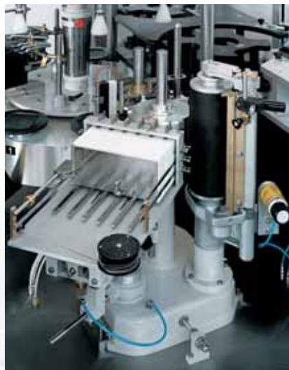
**IT** Stazione di etichettaggio ricavata in unica fusione.
