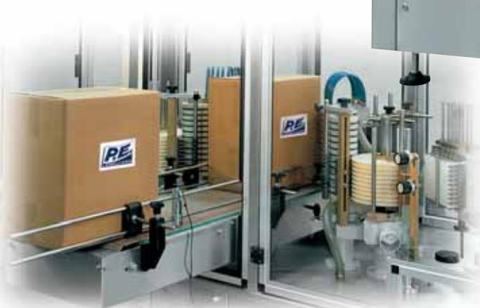
**IT** • Rotazione magazzino etichette solo in presenza del cartone da etichettare con comando a fotocellula regolabile per differenti formati.
