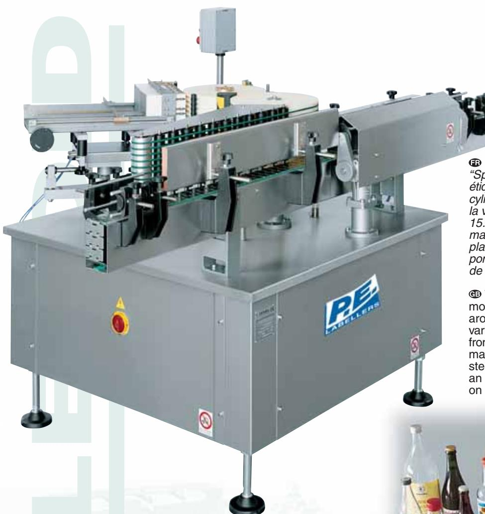
**IT** **Etichettatrici lineari a magazzino mobile.** Consentono di applicare un'etichetta di corpo parziale o avvolgente su contenitori cilindrici. I differenti modelli "Splendid" sono idonei per produzioni da 2.000 a 15.000 BPH. Struttura e corpo macchina interamente ricoperti da robuste lastre in acciaio inox. Distribuzione della colla mediante pompa pneumatica con riciclo continuo. Incollaggio dell'etichetta a strisce orizzontali.
